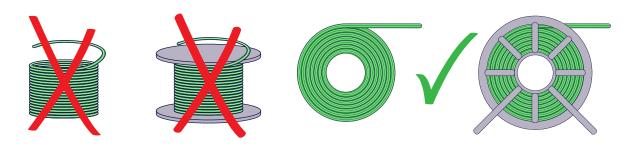
In der Energieführungskette müssen Leitungen so verlegt werden, dass sie sich in Längsrichtung frei bewegen können und im Radius nicht den Innen- oder Außenradius berühren.
