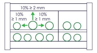
Bei Leitungen mit unterschiedlichen Außenmantelmaterialien empfehlen wir ebenfalls eine Separierung durch Trennstege, um ein Verkleben der verschiedenen Leitungen zu vermeiden.
