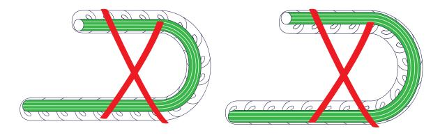
Bei einem linearen so wie horizontalen Verfahrweg sind elektrische Rundleiter und Pneumatikschläuche an beiden Seiten unmittelbar nach der Energieführungskette zugentlastend zu befestigen.
