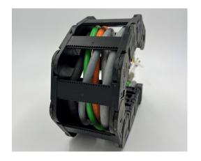
Bei der Befüllung einer Energieführungskette ist zu vermeiden, dass sich Leitungen und Schläuche überschlagen können oder Zugkraft auf die Energieführungskette im Innenradius ausüben.
