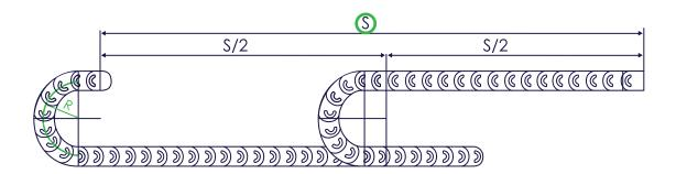
Ein wichtiger Faktor für die Erfüllung der voraussichtlichen Lebensdaueraussage einer Leitung ist die Einhaltung des maximalen Verfahrwegs der Anwendung. Eine Information des maximalen Verfahrwegs finden Sie auf dem jeweiligen Datenblatt der Leitung.
