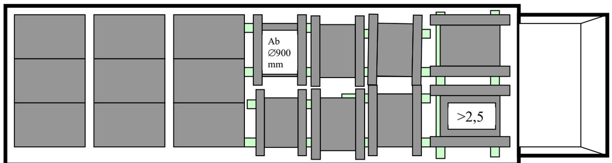
Trommeln (ab Größe  $\varnothing$  900mm) bis 2,5 Tonnen müssen quer zur Fahrtrichtung geladen werden, Trommeln über 2,5
